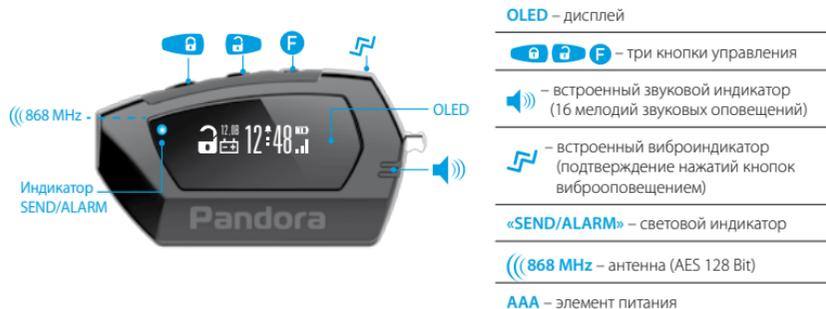
**!** Все команды управления передаются по радиоканалу, при работе с брелоком, для достижения максимальной эффективности и максимальной дальности радиосвязи, рекомендуется не закрывать пальцами рук зону встроенной антенны (см. Рисунок). Брелок является унифицированным средством управления, функции брелока зависят от модели охранной системы.
