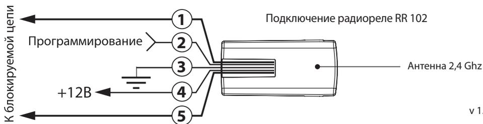
Радиореле блокировки со встроенным акселерометром допускается располагать в моторном отсеке. При этом недопустимо экранировать зону встроенной антенны 2,4 ГГц. Необходимо обеспечить жесткое крепление к кузову автомобиля или неподвижным жгутам проводов. Запрещено прятать в жгуты проводов. Радиореле может быть подключено как на постоянное питание, так и на питание от зажигания. Реле нормально замкнутое, блокировку осуществляет только при наличии несанкционированного перемещения автомобиля.
