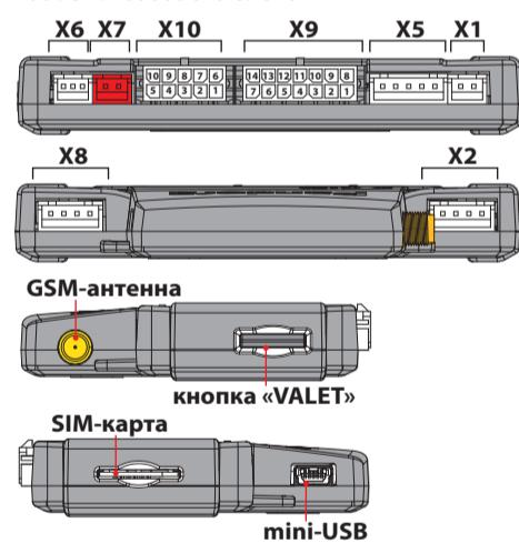
X1 - Разъём микрофона
